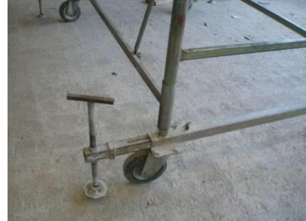
um auf die Arbeitsebene zu gelangen, ist eine innenliegende Leiter vorzusehen die Radsperre aktivieren Va prevista la scala interna per accedere al piano di lavoro Bloccare le ruote
